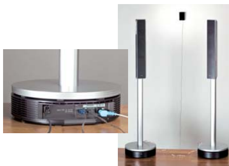
À l'arrière, à la "station de réception" infrarouges de Sony DAV-DZ700FW sont liés les 2 haut-parleurs satellites et une diode placée en hauteur. Ces appareils "sans fil" ont donc 4 câbles !
