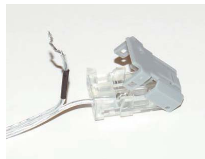
Certaines fiches peuvent être ouvertes pour remplacer le câble (pour le rallonger par exemple).
